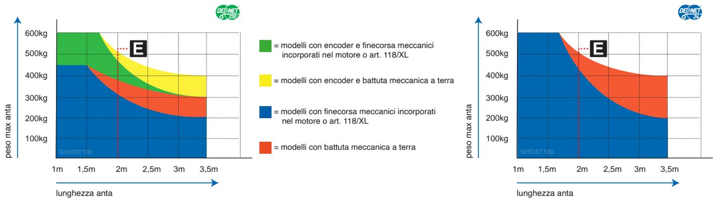
Se la lunghezza dell'anta è maggiore ai 2m o se si utilizzano modelli reversibili è necessario installare l'elettroserratura per il blocco del cancello in posizione di chiusura. L'altezza e la struttura dell'anta, così come la presenza di vento forte, possono causare la riduzione del valore dei dati riportati in tabella o rendere necessario l'utilizzo dell'elettroserratura anche per ante sotto i 2m di lunghezza.
