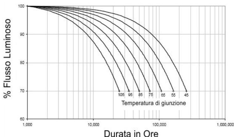
incassato in un controsoffitto, la temperatura ambiente a cui ci riferiamo sarà quella all'interno del controsoffitto in prossimità del corpo illuminante. Più aumenta la  $T_a$ , più diventa difficoltoso lo smaltimento del calore prodotto dal corpo illuminante e più aumenta la temperatura di giunzione del LED. Di conseguenza peggiorano i parametri prestazionali.
