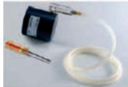
Si eroga gas tramite il Kit di calibrazione collegato alla bombola di gas campione.
