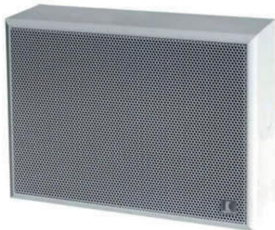
Diffusore da parete per sistemi di allarme vocale. Questi diffusori sono stati appositamente sviluppati per essere impiegati in sistemi d'emergenza e d'evacuazione (VES): sono infatti dotati di morsettiera ceramica e di fusibile termico, che garantiscono la sicurezza della linea di collegamento altoparlanti.
