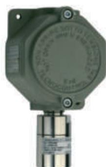
Rilevatore Gas industriale, con cartuccia sensore sostituibile. Certificato ATEX per zona 1. Marcatura Atex: II 2G Ex d IIC T6 Gb; 1 uscita lineare 4÷20 mA; Morsetti ad innesto polarizzati 3 relè di Allarme a stato solido. Carico resistivo MAX 24V/1A SPST; 1 relè di Guasto a stato solido. Carico resistivo MAX 24V/1A SPST; Livelli di allarme (Relè) programmabili tramite Dip-Switch. Tensione di alimentazione 9-27Vcc. Assorbimento 55mA. Temperatura di esercizio 0°-40°C.
