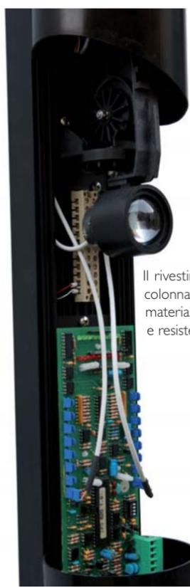
Il rivestimento tubolare esterno della colonna IPS è in policarbonato, materiale particolarmente leggero e resistente.
